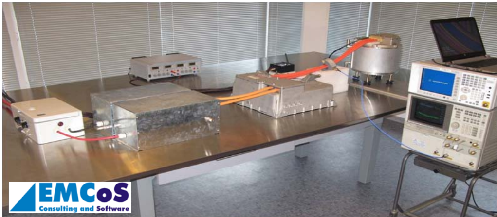
სურათი 1. ელექტრომობილის მაღალი ძაბვის ძალოვანი სისტემის ლაბორატორიული დანადგარი
